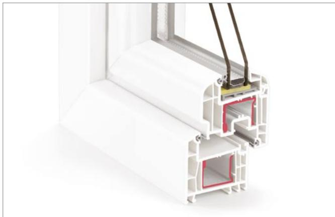
sistema finestra è dotato, fungono da barriera isolante tra le basse temperature esterne e il calore degli ambienti interni. Il risultato è un eccezionale valore di trasmittanza termica, pari a  $U_f^* = 1,3 \text{ W/m}^2\text{K}$ . Le finestre con REHAU Brillant-Design sono pertanto ideali per le nuove costruzioni a basso consumo energetico, per le ristrutturazioni orientate al risparmio energetico e per ridurre i costi di riscaldamento.
